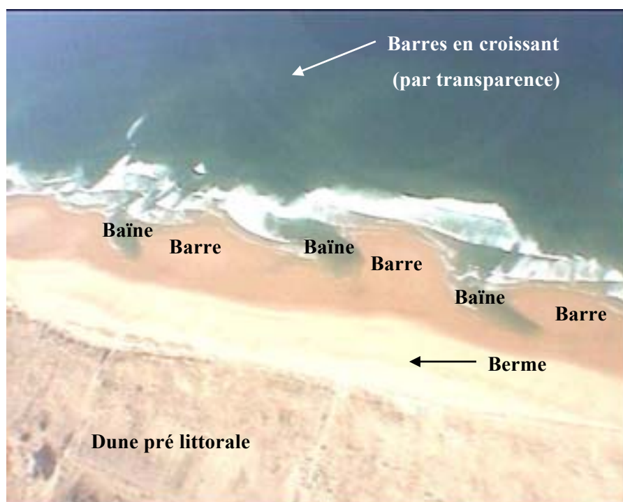
Figure II.2 Vue aérienne de la morphologie du site atelier de la plage du Truc Vert, des barres en croissant subtidales jusqu'à la dune pré littorale.
