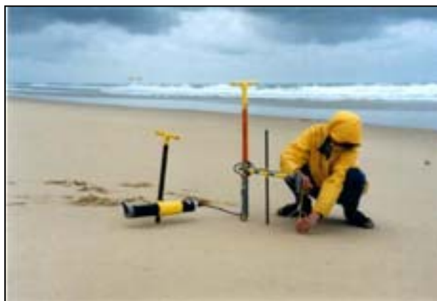
Figure II.8 Déploiement de l'Acoustic Doppler Velocimeter.
