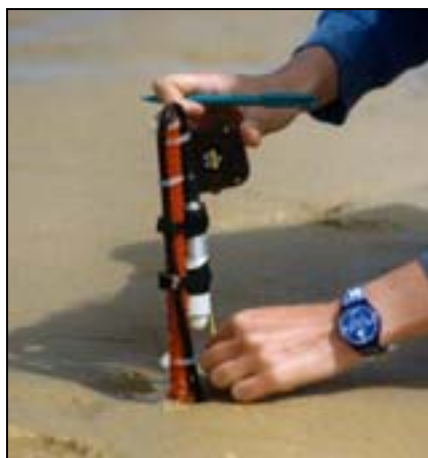
Figure II.7 Déploiement des capteurs de pression piézoresistifs
