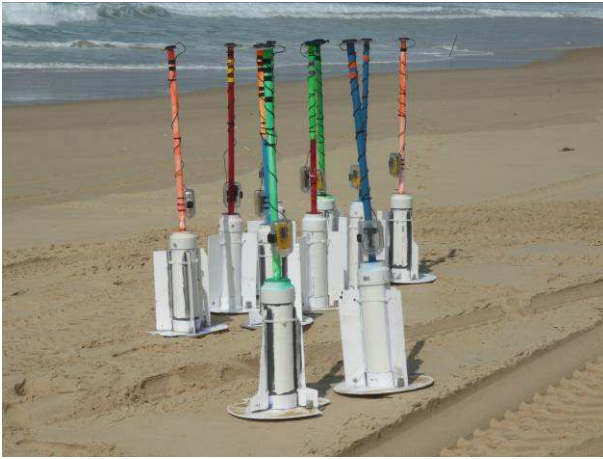
Figure 13. Photographie de driffters utilisés sur la plage du Truc-Vert en mars-avril 2008. Ils sont composés d'un flotteur, d'un fanion pour le repérage, d'un GPS étanche et d'une carte de stockage des données. On enregistre la position et la vitesse de la bouée pour reconstituer le champ de courant
